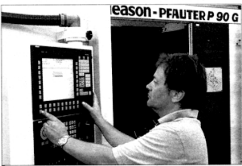
Суперсовременный станок с ПУ для обработки зубчатых колес.
