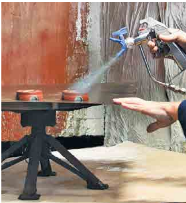
Окрасивание деталей с помощью пистолета-распылителя.
